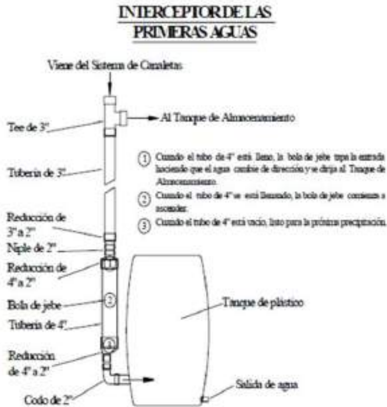
Ilustración 86 – Interceptor de las primeras aguas.
