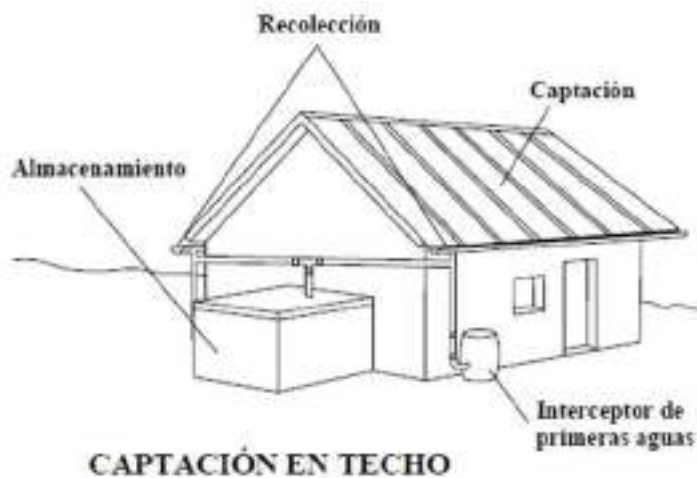
Ilustración 85 - Sistema de captación de agua fluvial en techos
