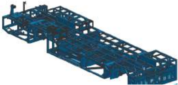
Ilustración 6 - Carrocería de aluminio acoplada al chasis de acero
