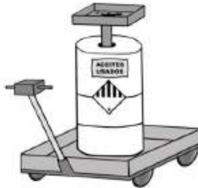
Imagen 37 – Recipiente para drenaje de aceites usados
