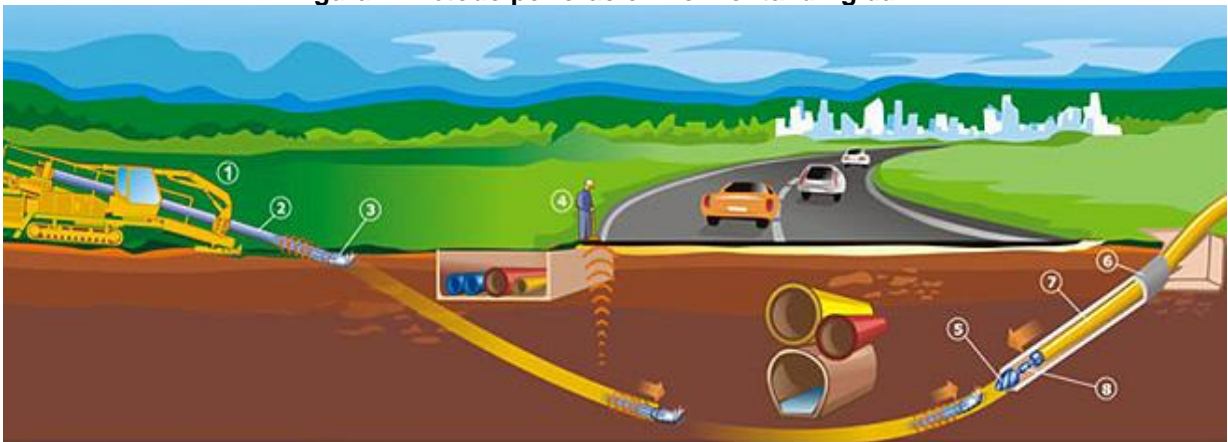
Figura 4. Método perforación horizontal dirigida
