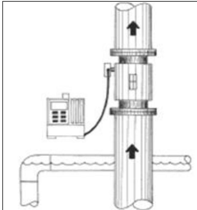
Para lograr precisiones apropiadas, cualquier codo de 90 o 45 grados, estrechamientos, válvulas parcialmente abiertas, etc. Deben ubicarse a no menos de 10 diámetros aguas arriba, y a dos diámetros aguas abajo.
