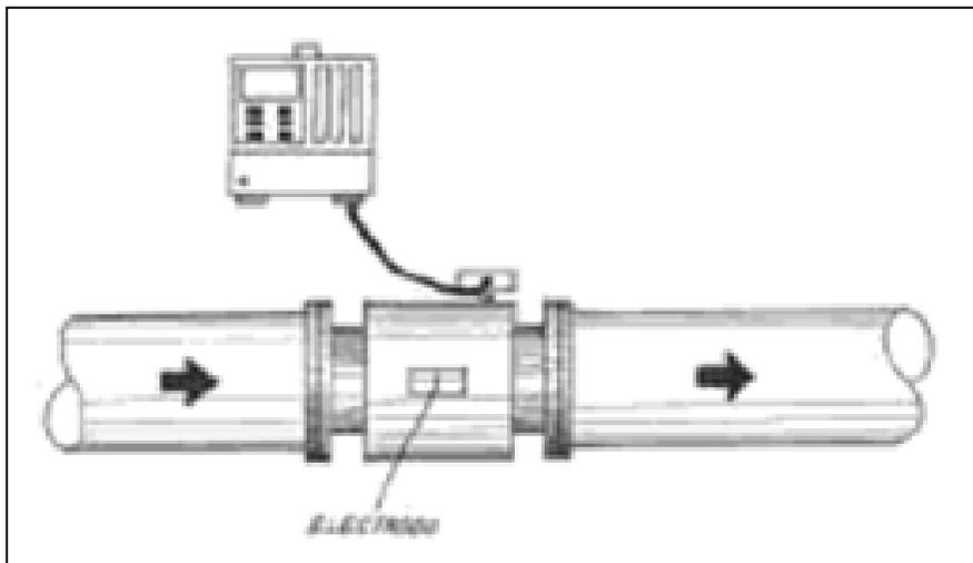
En tramos verticales de tuberías, el flujo debe ser ascendente. Para aplicaciones donde habrá que medir fluidos muy espesos o mezclas de líquidos y sólidos (aguas residuales), la posición vertical asegura una óptima distribución de los sólidos en las condiciones de escurrimiento.
