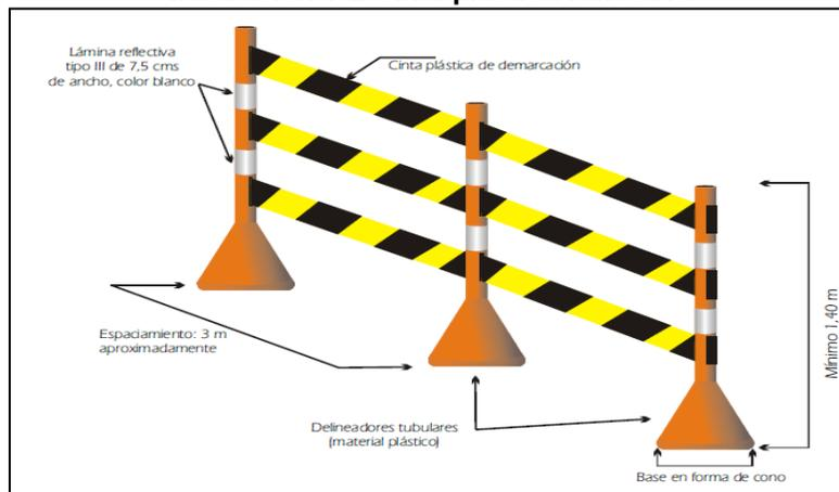
La cinta plástica de seguridad se fabrica en polietileno de 4 milésimas de pulgada, con un ancho de 0.075m., en fondo de color amarillo con franjas negras de 0.15 m. Incluidas a 45 grados y se instalarán en dos hileras convenientemente separadas. Este tipo de barrera servirá para delimitar el perímetro general de las obras y específicamente el de cada uno de los frentes de obra que están bajo intervención del CONTRATISTA, todo ello con la supervisión y aprobación de la Interventoría.
