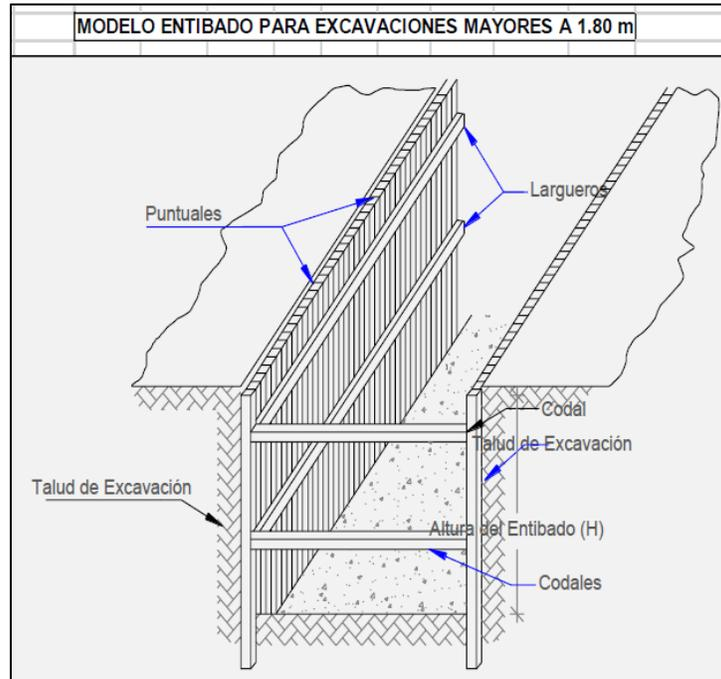
Se recomienda que las excavaciones para la instalación de la tubería se haga con taludes verticales máximo hasta 1.80 m, de ahí en adelante se debe entibar la excavación con codales y puntales cada m, como se indica en la figura siguiente.
